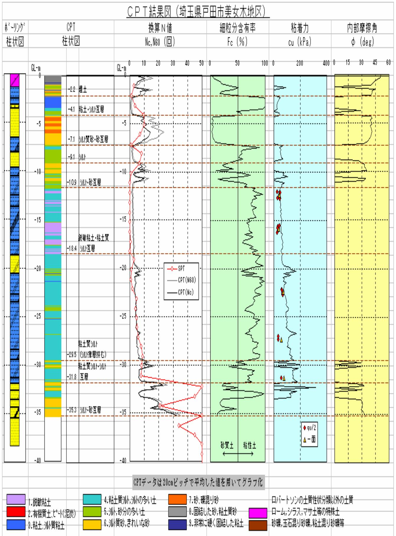
消散試験から圧密係数( $C_v$ )を求め、 $q_c$  から体積圧縮係数  $m_v$  を求めることで、粘性土層の圧密沈下や不同沈下の検討が可能です。
