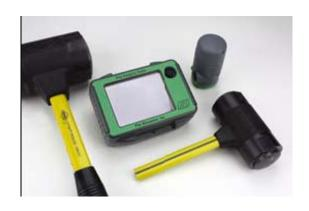
低ひずみ型動的杭インテグリティテストは、 基礎杭の健全性や長さなどを試験する方法 として古くから使われてきました。米国Pile Dynamics (PDI社)は1991年、最初 にパイル・インテグリティテスター(PIT)を 開発し、その後、パルスエコ試験と呼ばれて 数多くの実績を築いてきました。この試験方 法は、今ではASTM D5882に低ひずみ型動的 杭インテグリティテストに規格化されてい ます。
