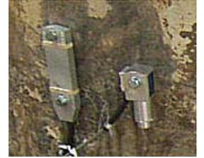
ひずみ計, 加速度計
